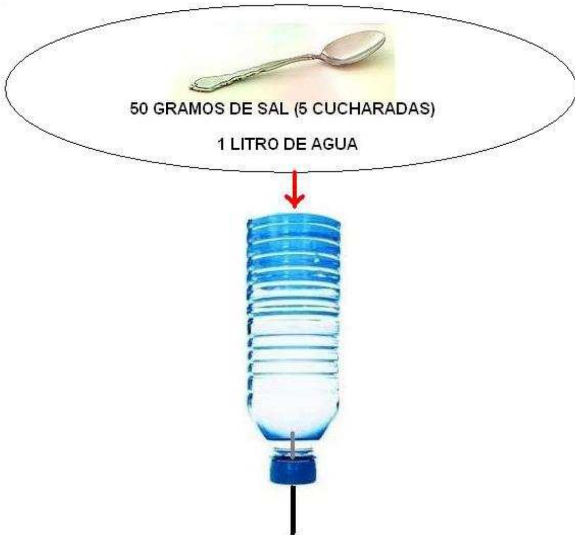
Pelamos dos cables, uno lo introducimos por la parte superior y el otro lo conectamos al grafito (mina), la distancia entre cable y grafito debe de ser de unos 20 centímetros de distancia. Después conectamos 12 voltios (negativo al cable y positivo al grafito), esperar 2 horas como mínimo.
